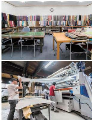
革漉（かわすき）とは、革を薄くスライスして厚さを調整する加工。日本における革漉加工の元祖がこの墨田革漉工業です。さらにエンボス（型押し）、パンチング（穴開け）、フイルムや箔を貼る、ブリーフ、デジタルカッティング（ナイフで切れ目を入れる）…と、さまざまな後加工を手がけ、革業界では頗りにされる存在です。
