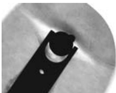
図6 シャンクとセンターピン頭部のX線画像 (シャンク1とセンターピン5)
