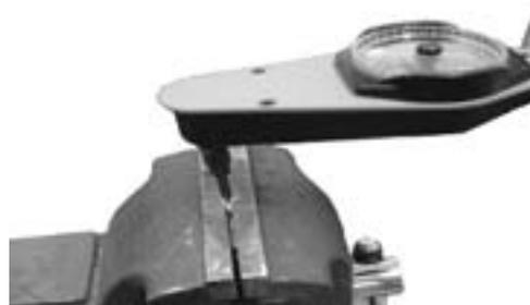
図4 センターピンのねじり破断強さ測定
