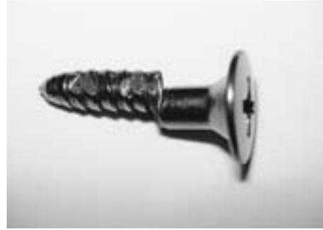
図8 ねじり破断強さ測定後のセンターピン5
