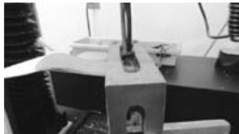
図3 中底のセンターピン保持力測定
