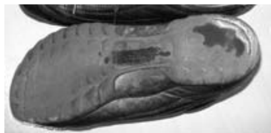
写真14 EVA製表底の激しい摩耗
