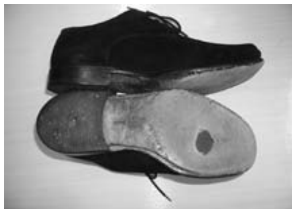
写真10 革製表底の摩耗
