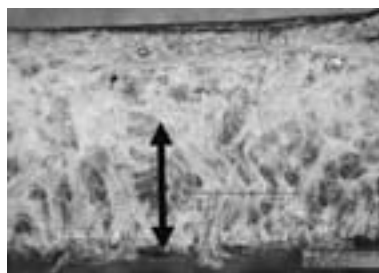
写真7 トウシューズの底革断面
