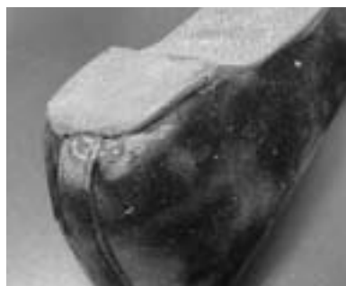
写真15 トップピースの摩耗
