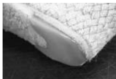
写真16 ウェッジヒールの摩耗
