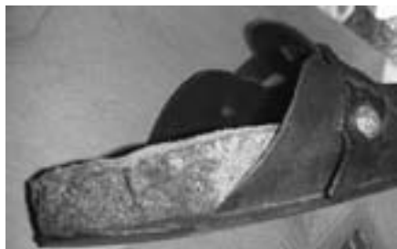
写真2 ミッドソールのひび
