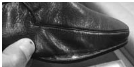
写真3 ボール部の剥離
