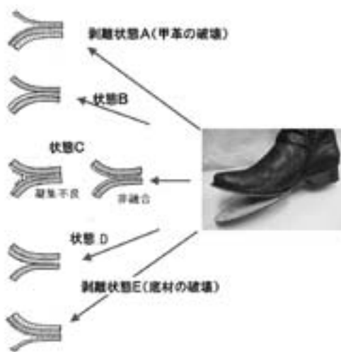
図3 剥離状態の分類
