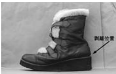
写真5 シート部の剥離
