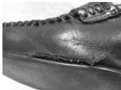
写真4 フェザーライン切れ
