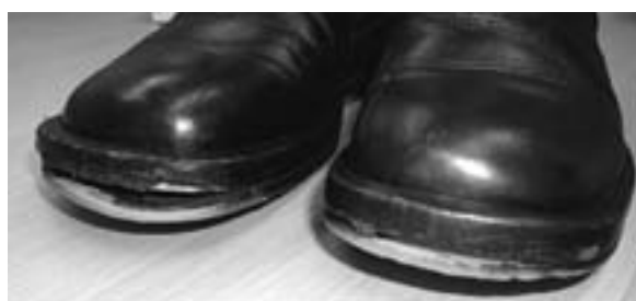
写真2 プラットフォームの剥離
