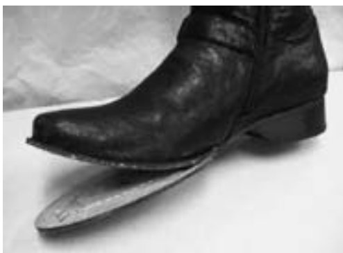
写真6 靴底の剥がれ
