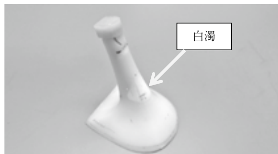
図7 ヒール衝撃試験後のヒール (12.9 J変形)
