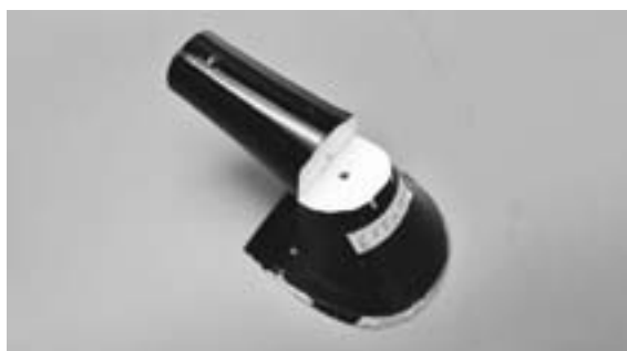
図6 ヒール衝撃試験後のヒール (6.1 J破壊)
