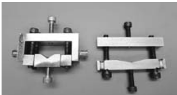
図3 ヒール取付強さ測定用治具 (ヒールの形状により使い分ける)
