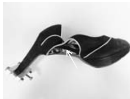
図9 ヒールが取れる前に靴が破壊した例 (中底と表底の剥離。ちなみにこのときの値は1,190N)
