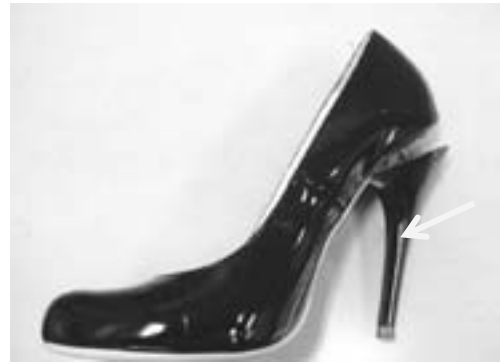
図11 後方からの力でヒールが取れた事例
