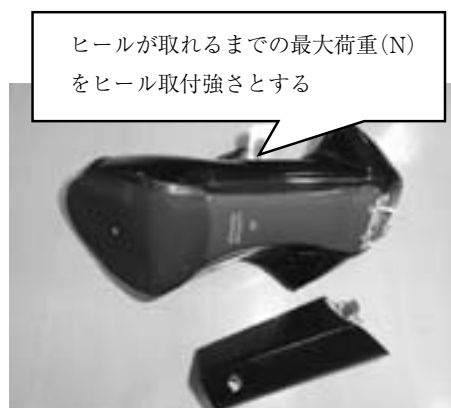
図8 ヒール取付強さ測定後の試料
