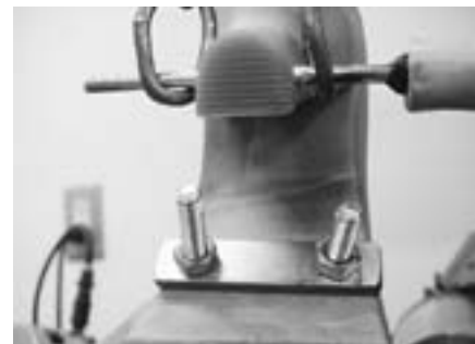
図6 ヒールに開けた穴に金属棒を通し引張試験機に装着
