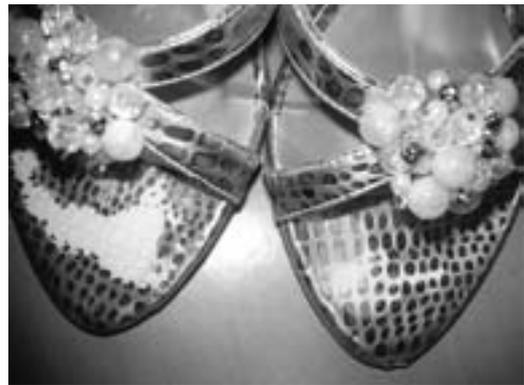
図1 婦人用サンダルの中敷が短期間で摩耗した例
