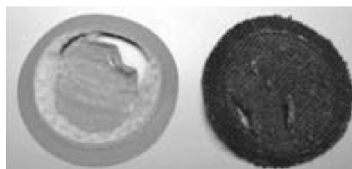
図10 マーチンデール摩耗試験（湿潤）後の試料(2)
