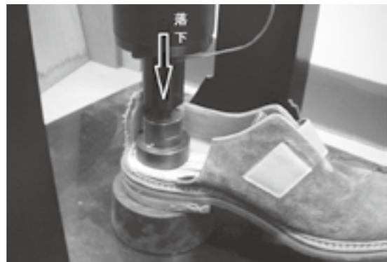
写真1 圧縮エネルギーの動力的測定法
