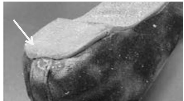
図2 ポリウレタン製トップピースの著しい摩耗
