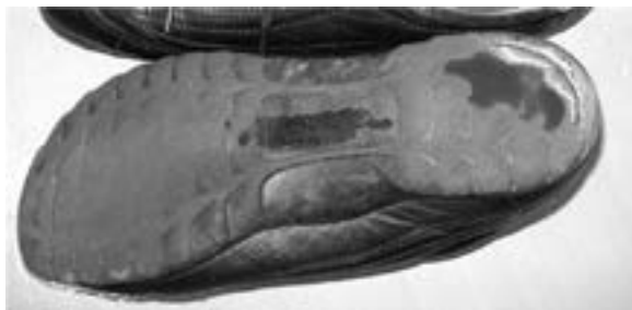
図1 エチレン酢酸ビニル共重合樹脂 (EVA) 製表底の著しい摩耗
