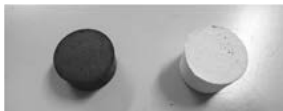
図5 標準ゴム (左) と試料 (右)
