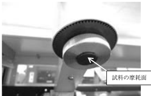
図6 試料装着状態
