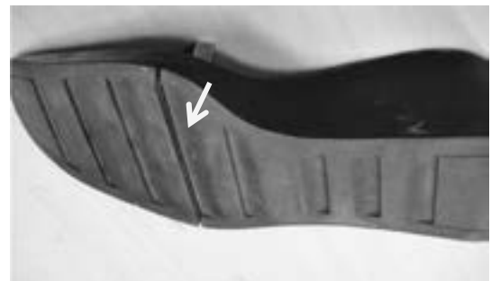
図3 表底にき裂が生じた事例
