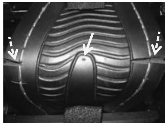
図12 耐屈曲性試験後の試料の一例（屈曲回数30,000回）
