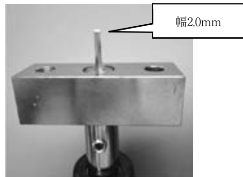
図8 刃部分の拡大図
