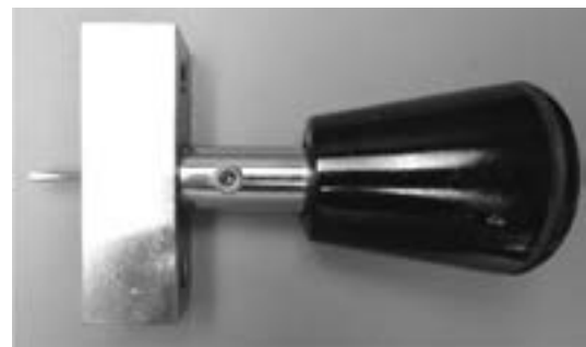
図7 切り込みを入れるためのカッター
