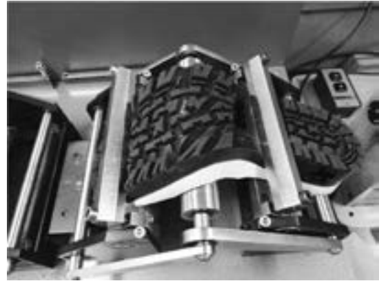
図11 表底の耐屈曲性試験（最大屈曲状態）
