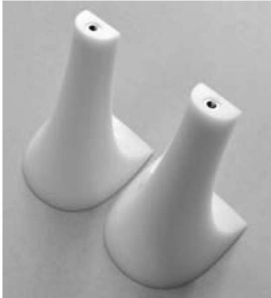
図2 補強芯入りABS樹脂ヒール (左：91-素-補強芯入り、右：107-素-補強芯入り)
