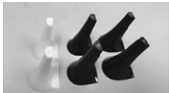
図1 補強芯なしのABS樹脂ヒール 奥：左から91-素、91-L、91-U 手前：左から107-素、107-L、107-U
