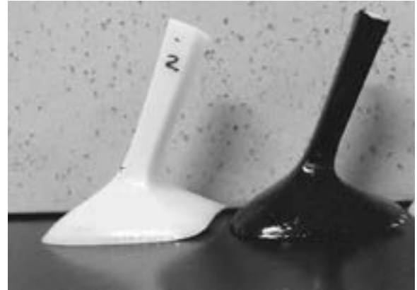
図3 平成15年度に入手した補強芯なしのABS樹脂ヒール(左：A-素、右：A-U)
