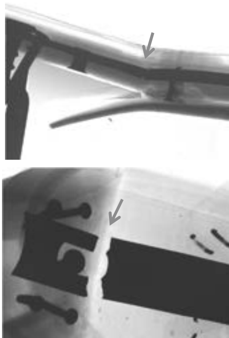
図5 シャンクの損傷事例
