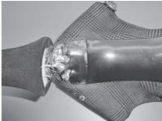
図3 中底のヒールピン保持力が低いために起きたヒール取れ事故の例
