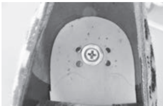
図2 ヒールピンによるヒールの固定
