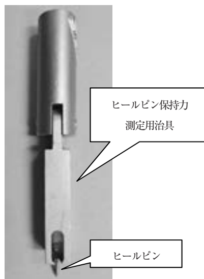
図4 ヒールのヒールピン保持力測定用治具
