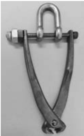
図9 ヒールのヒールピン保持力測定用治具の一例
