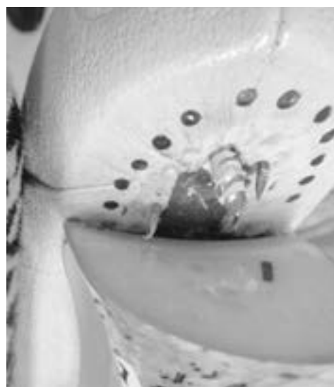
図3 ヒールからヒールピンが抜けてヒールが取れた事例
