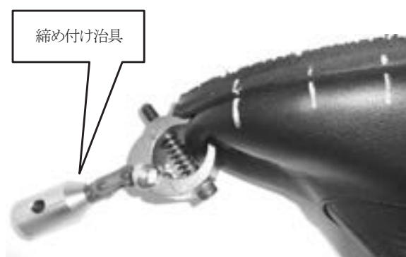
図3 甲部の爪先先端部を締め付け治具でつかむ
