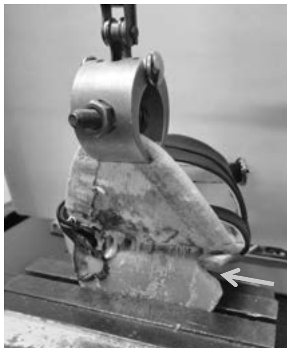
図7 クレープ製表底が破壊し測定を続けることが困難
