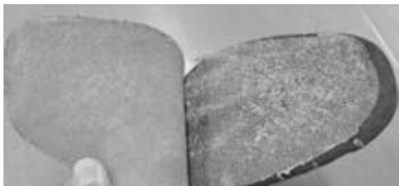
図9 JIS T 8101に準じた試験後の試料(1) 表底全面が接着されている場合
