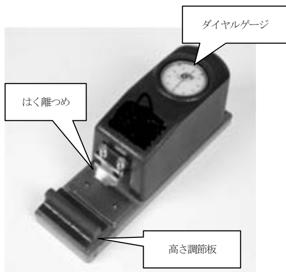
図3 爪先はく離試験機
