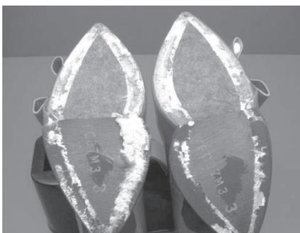
図1 「表底はく離強さ」を測定した後の試料
