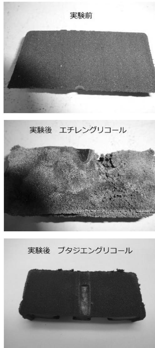
図2 アルカリ溶液浸漬による外観変化
