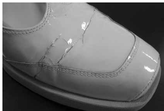
写真5 エナメル革の屈曲割れ
