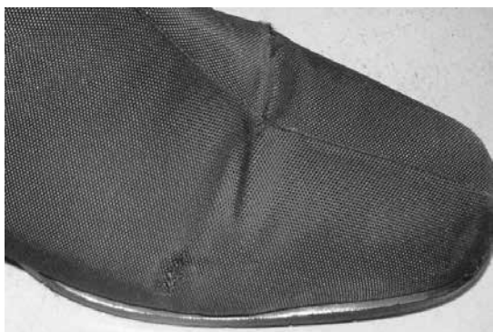
写真3 ストレッチ素材の屈曲割れ
