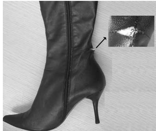
写真9 ブーツ後部の縫い目切れ
