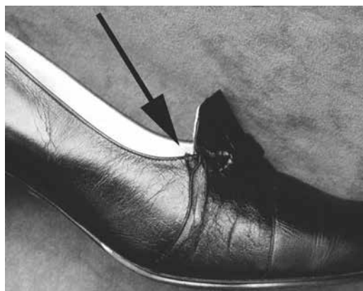
写真13 トップラインの縫い目切れ
