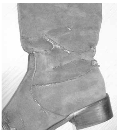
写真4 ポリウレタン製ブーツのひび割れ
