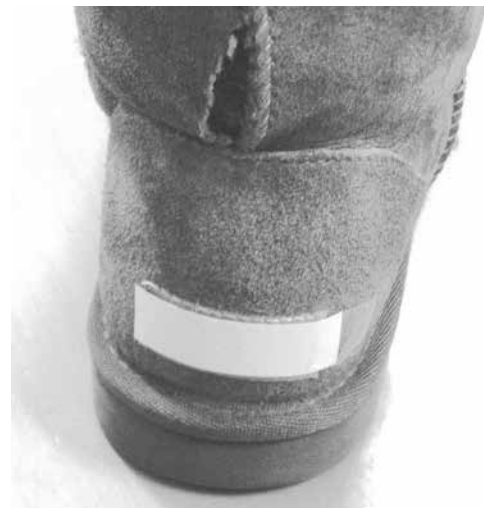
写真10 ブーツ後部の縫い目切れ
