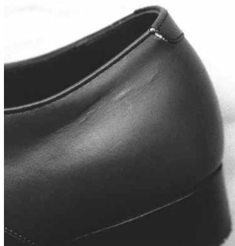
写真14 トップライン踵部の縫い目切れ
