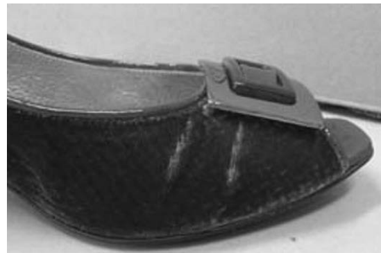
写真2 ビロード調織物の屈曲割れ
