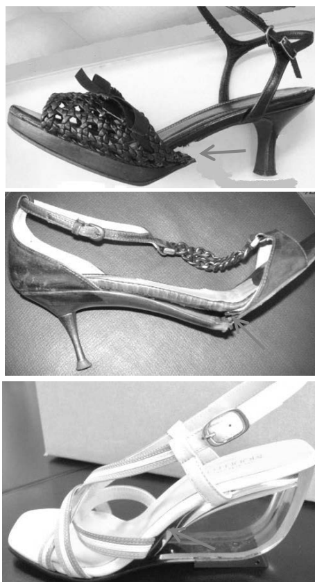
図1 着用中に靴の部品のはく離や折れが生じた事故例
