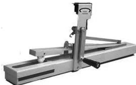
図1 摩擦試験機I形 (クロックメータ) の外観
