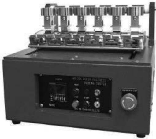
図7 摩擦試験機Ⅱ形（学振形）
