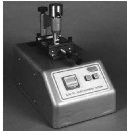
図8 ISO 11640で使用される摩擦試験機
