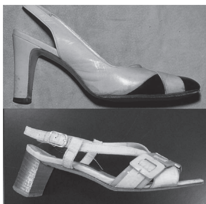
写真2 シャンクが破損した靴の外観
