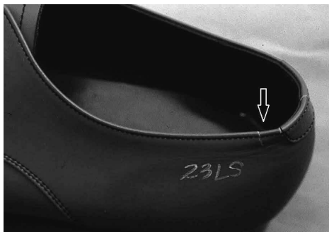
写真7 トップラインに生じたき裂
