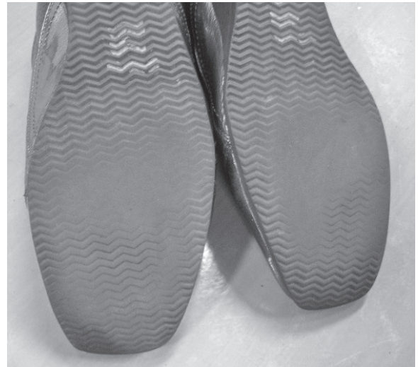
写真15 均一でない摩耗程度
