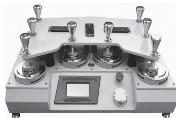
図4 マーチンデール形摩耗試験機
