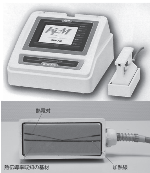
QTMプローブの構造 図7 迅速熱伝導率計とプローブ
