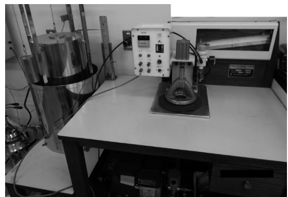
図3 フラジール形準拠通気性試験機
