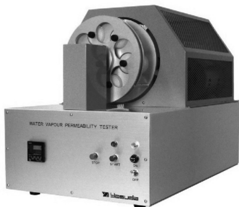
図4 皮革透湿度試験機
