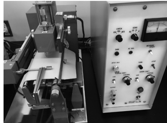
図2 KES-FB4 表面試験機
