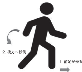
図2 前足のかかところが歩行面に接触し前方へ滑り、後方へ転倒
