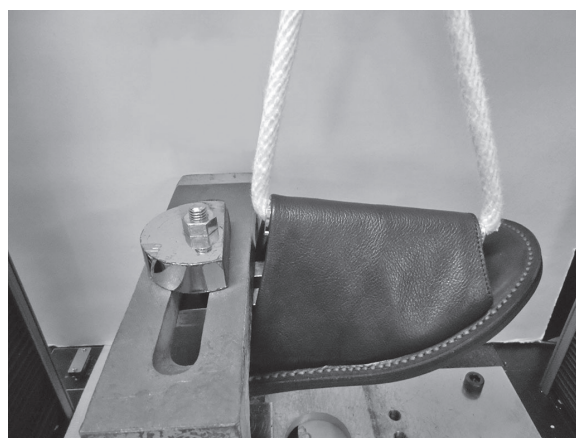
図1 バンドの取付強さ試験 (1枚甲バンドのサンダル)
