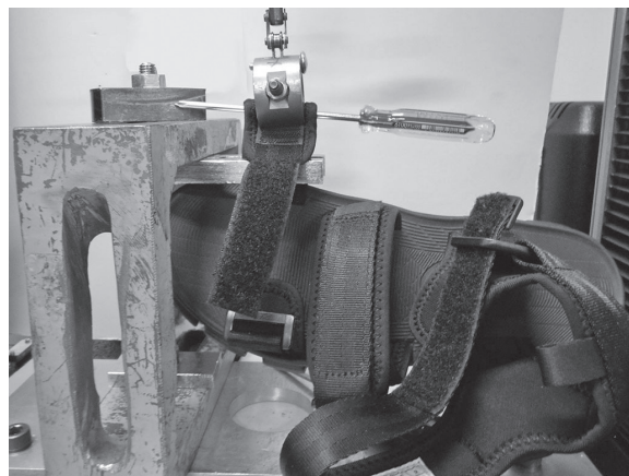
図2 バンドの取付強さ試験 (スポーツサンダル)
