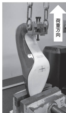
図2 ISO 22650によるヒール取付強さの測定
