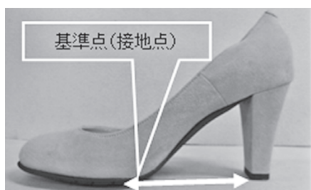
図3 靴底の接地点とトップピースの前端までの距離測定
