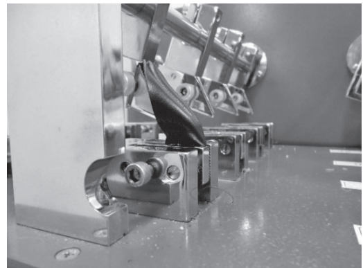
図3 試験片を屈曲させた状態
