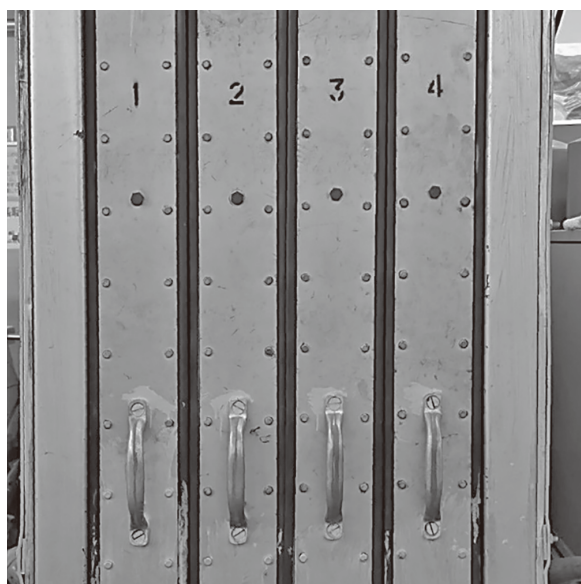
図8 革を固定する平板。平板1枚当たり2枚の革を固定できる。平板を収納すると端部のパッキンにより密閉される。
