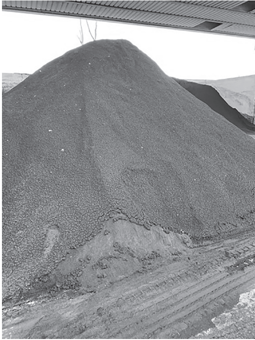
クオイオデプーラ社排水処理場で処理された汚泥
