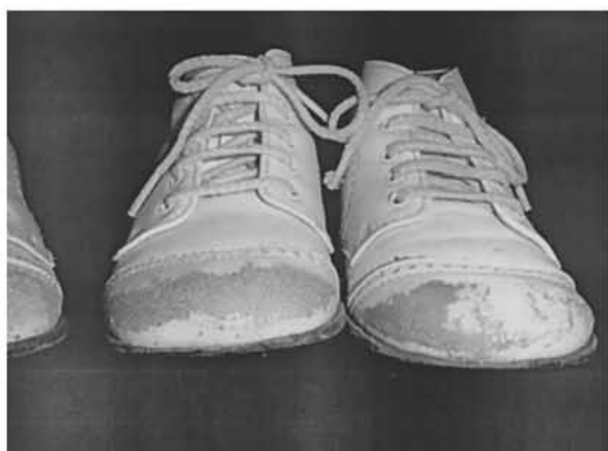
つま先の損傷
