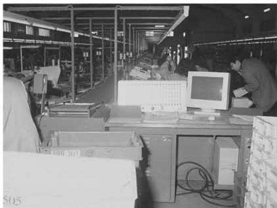
ベルトコンベヤーを挟んでマシンが並ぶ製甲ライン。これもコンピューターで管理されている。
