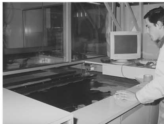
革にも自動裁断機が使われ始めている。モニターを見ながら、革の傷や取り都合を考慮しパターンを並べて行く。
