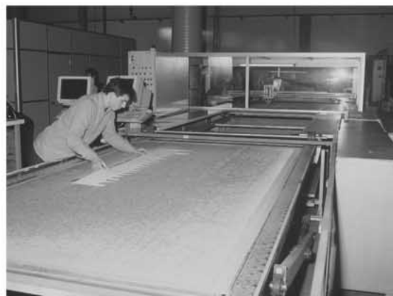
ウオータージェット・カッター。主に裏材などの裁断に用いられている。
