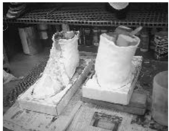
(写真7) 陰性モデルに樹脂を注入 樹脂の場合は、軽くするために中に木片をいれる
