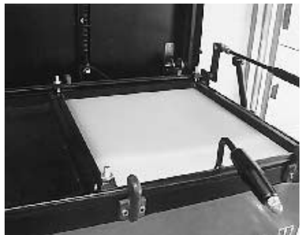
(写真26) バキュタムに(写真29)の素材をセットし、上部のヒーターで暖める
