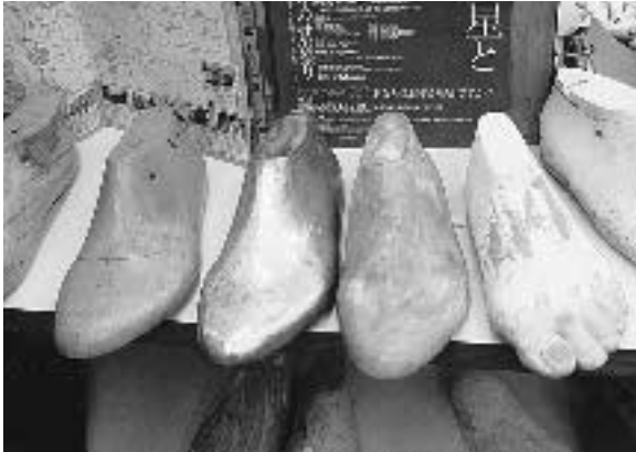
(写真22) 木型、アルミ型、樹脂型、石膏型。写真(1と21~22)はG靴店。
