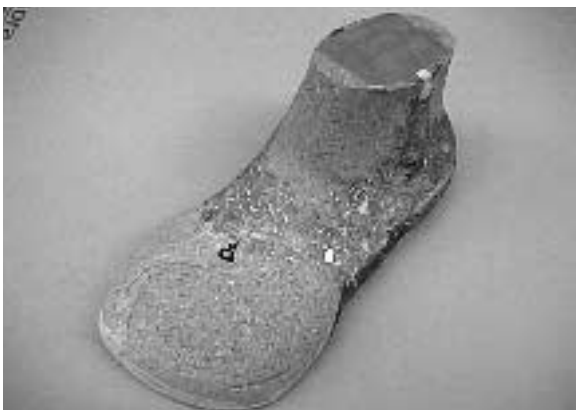
(写真23) 陽性モデルから作成した靴型
