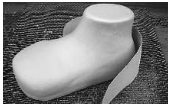
(写真33) カウンターを付ける。補強したところがデザインになるように工夫する
