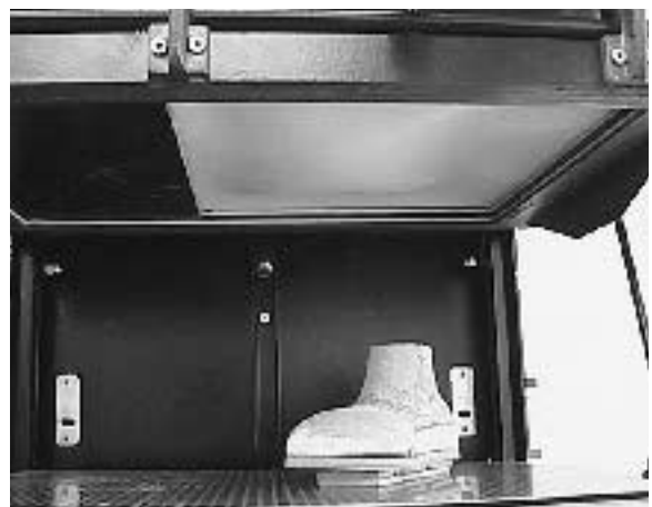
(写真27) 足底挿板をセットした靴型をバキュタムに置く
