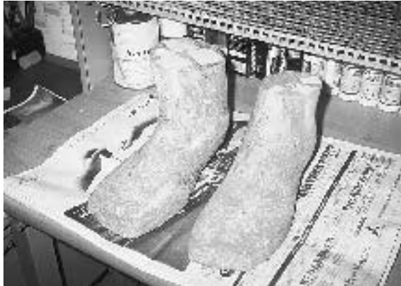
(写真9) 靴型になるように修正 陽性モデルそのままでは靴にならない。一番重要なところ。
