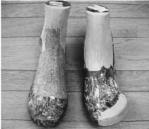
(写真42) 陽性モデルから製作した靴型
