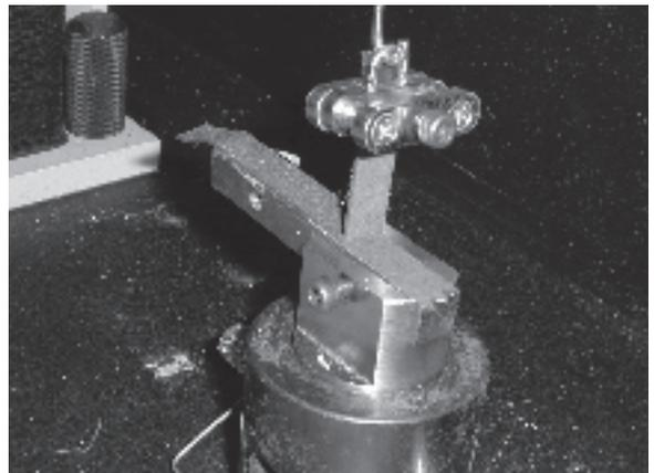
仕上げ膜の剥離強さ試験
