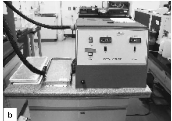
図2 SATRA耐滑性試験機STM 603(a)及び氷作成装置(b)の概観
