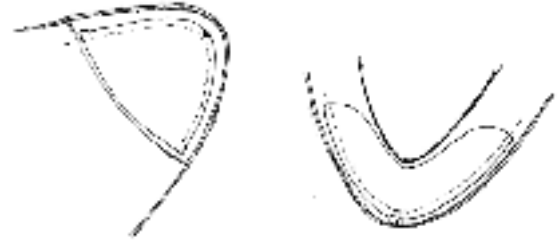
先芯とカウンターの挿入位置を示す
