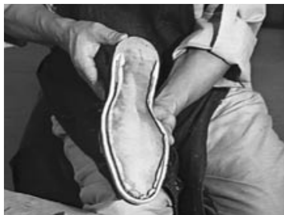
D 溝起（堀り）し作業
