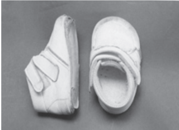
写真3 マジックバンドの位置不適によって靴先が破れたベビー靴
