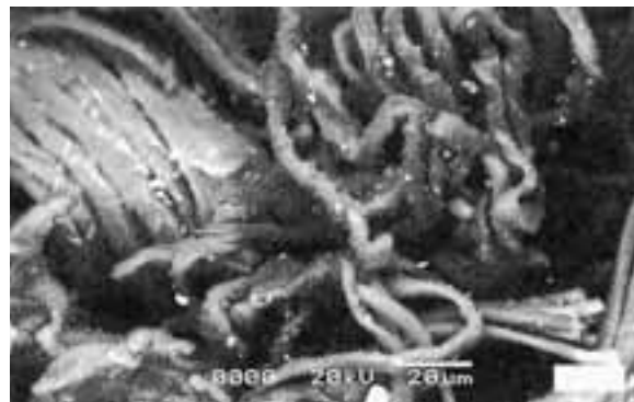
写真2 斑犀把漆鞞銀漆莊刀子2号帶執の表面 線維のよじれがある
