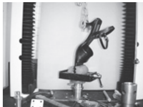
図1. ISO22650によるヒール取付強さ試験
